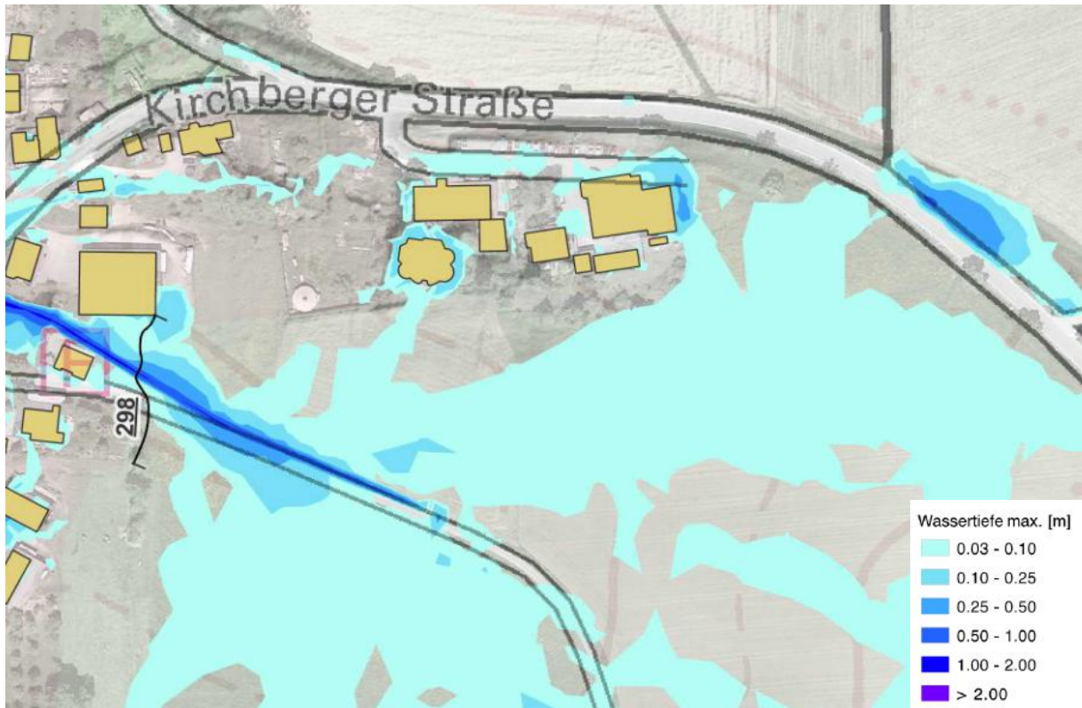
Bild 7: Maximale Überflutungstiefen „außergewöhnlich verschlämmt“ (CDM Smith), 1:2.500
